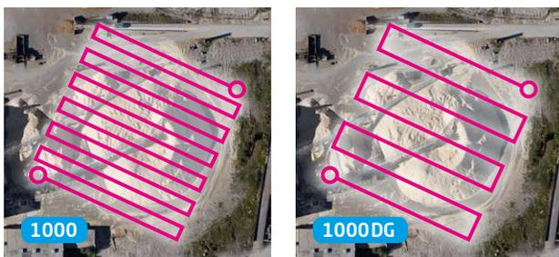
Vous constaterez sur l'image de droite que la réduction des recouvrements latéraux et longitudinaux qu'offre la solution de géoréférencement direct a permis au drone de couvrir davantage de terrain plus rapidement par rapport à la solution de triangulation aérienne de l'image de gauche. Le tableau ci-dessous indique le temps passé sur le projet et le nombre d'images prises.
