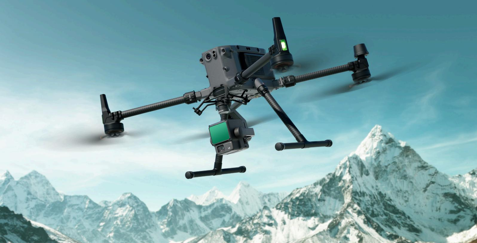
Zenmuse L2 est un système LiDAR aérien de haute précision permettant aux drones une collecte de données 3D plus précise et plus efficace. Avec une précision de 4 cm à la verticale et de 5 cm à l'horizontale et la capacité de couvrir une zone de 2,5 km<sup>2</sup> en un seul vol, ce système conforme à l'indice de protection IP54 permet aux utilisateurs la gestion aisée de nombreux scénarios opérationnels.
