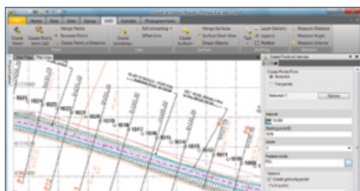
Créez automatiquement des points sur des déports horizontaux et verticaux à partir d'un alignement pour implantation
