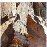
Le fissuromètre placé sur un rocher ou un ouvrage permet la mesure d'un glissement planaire sans basculement.
