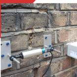
L'utilisation d'un fissuromètre électronique SENCEIVE permet d'observer en continu l'évolution d'une fissure et de prendre les dispositions nécessaires afin de prévenir les accidents.
