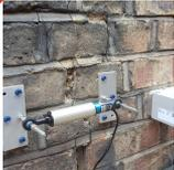
L'utilisation d'un fissuromètre électronique SENCEIVE permet d'observer en continu l'évolution d'une fissure et de prendre les dispositions nécessaires afin de prévenir les accidents.
