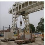
L'installation de quelques inclinomètres sur les portiques et ponts roulants permettra de mesurer une déformation de la structure sur ses montants ou sur le pont par lui-même.
