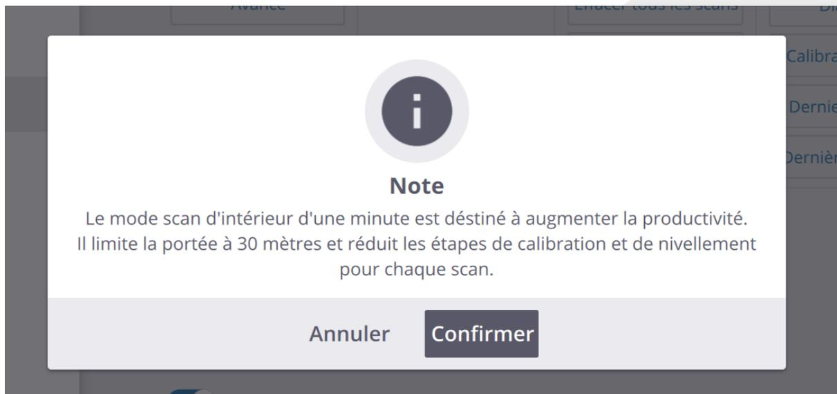
Passer dans le mode scan d'intérieur, permet d'aller plus vite sur le terrain en réduisant le temps des capteurs avant stations.
